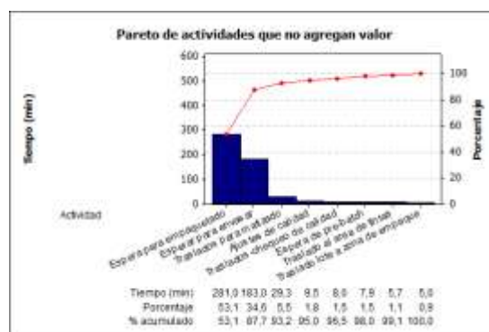
Figura 5: Diagrama de Pareto de las actividades que no agregan valor dentro del proceso de fabricación.
