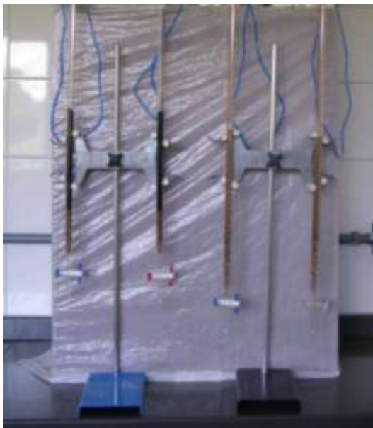
Figura N°5. Montaje de Columnas
