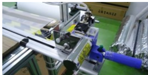
Figura 11. Máquina corte para material EVA y TPT
