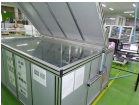
Figura 18. Máquina de inspección de defectos, mediante electroluminiscencia
