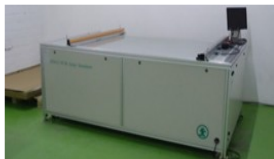
Figura 24. Máquina para evaluación de las características del panel solar (simulador solar)
