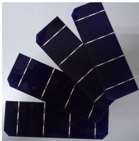
Figura 9. Celdas monocristalinas cortadas
