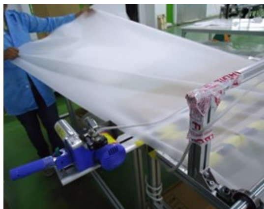
Figura 10. Mesa de apoyo para corte de EVA y TPT
