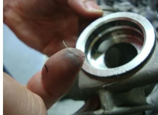
Figura 9 – Contaminação metálica encontrada na carcaça. Fonte: Empresa (2013)
