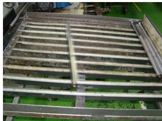
Figura 10 – Suporte da máquina de polimento externo. As cremalheiras batem uma na outra. Fonte: Empresa (2013)
