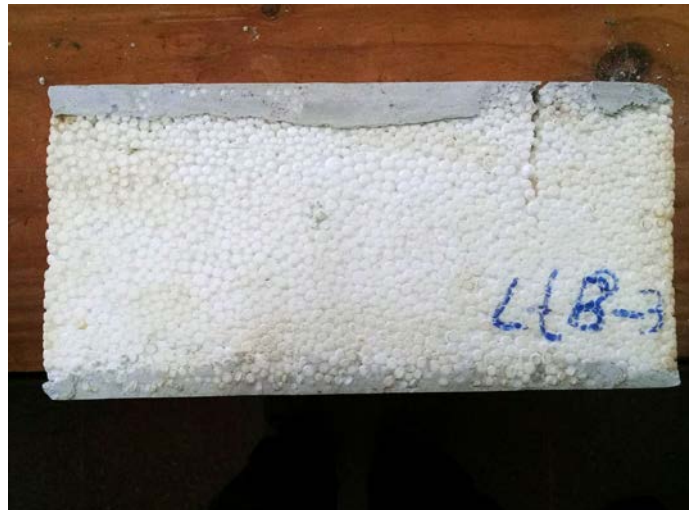
Fig. 13. Modos de falla en ensayos de ladrillos individuales.
