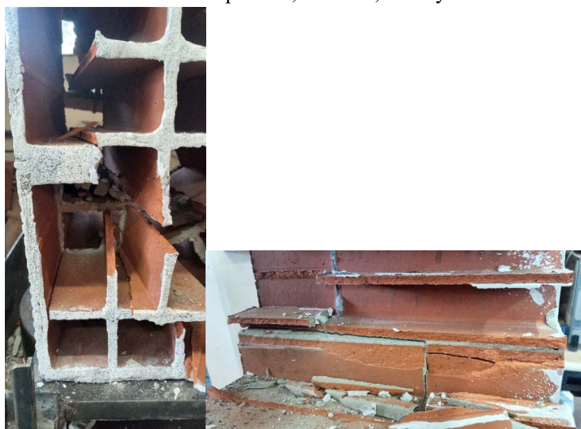
Fig. 12. Modos de falla en celdas CLCH-AC.
