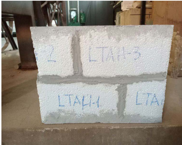
Fig. 4. Ladrillos en formato celdas de EPS unidos con adhesivo para cerámicas.
