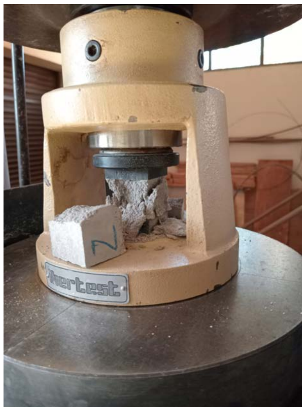
Fig. 15. Modos de falla en ensayos de probetas de mortero MC ensayados a compresión.
