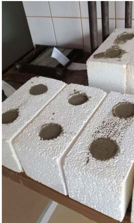
Fig. 2. EPS relleno con mortero de cemento 1:3.
