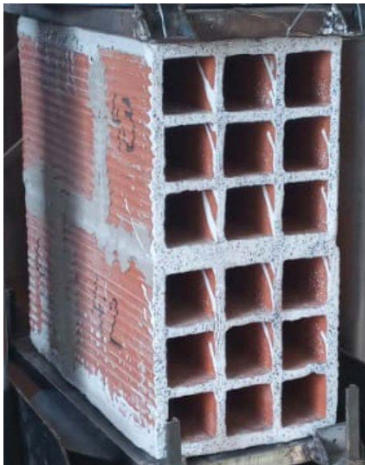
Fig. 5. Celdas de LCH unidos con adhesivo para cerámicas – CLCH-AC.
