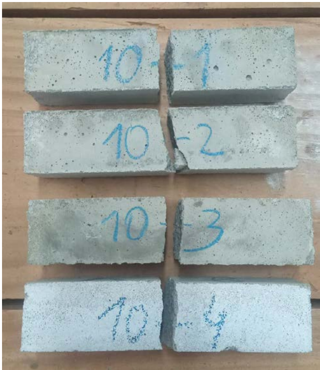
Fig. 14. Modos de falla en ensayos de probetas de mortero MC ensayados a flexión.
