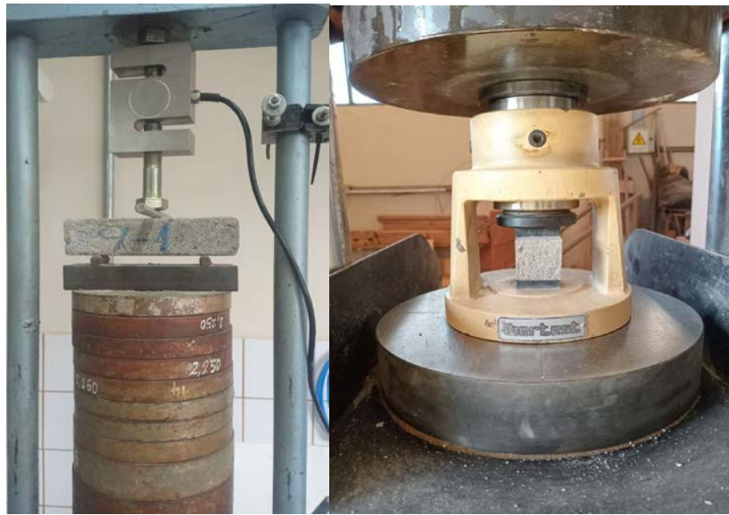
a) b) Fig. 9. Dispositivos de ensayo: a) a tracción por flexión; b) a compresión.
