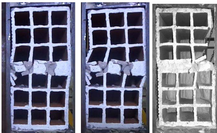
Fig. 11. Modos de Falla en celdas CLCH-CA.
