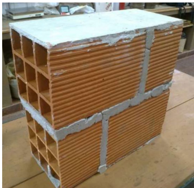
Fig. 6. Celdas de LCH unidos con mortero de cemento de albañilería – CLCH-CA.
