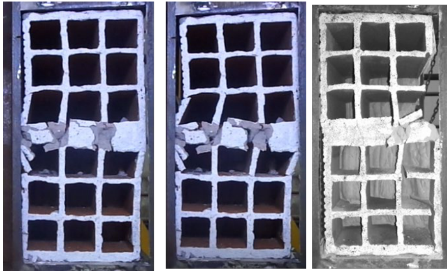
Fig. 11. Modos de Falla en celdas CLCH-CA.
