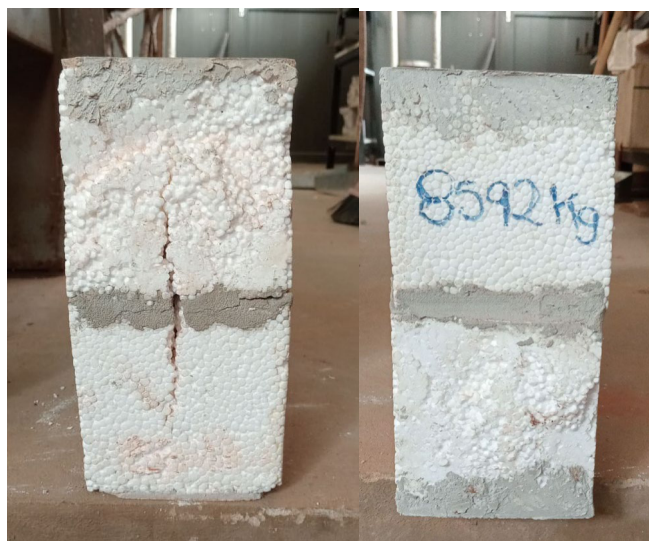
Fig. 10. Modos de falla observados en celdas de ladrillos EPS unidos con adhesivo para cerámicas.
