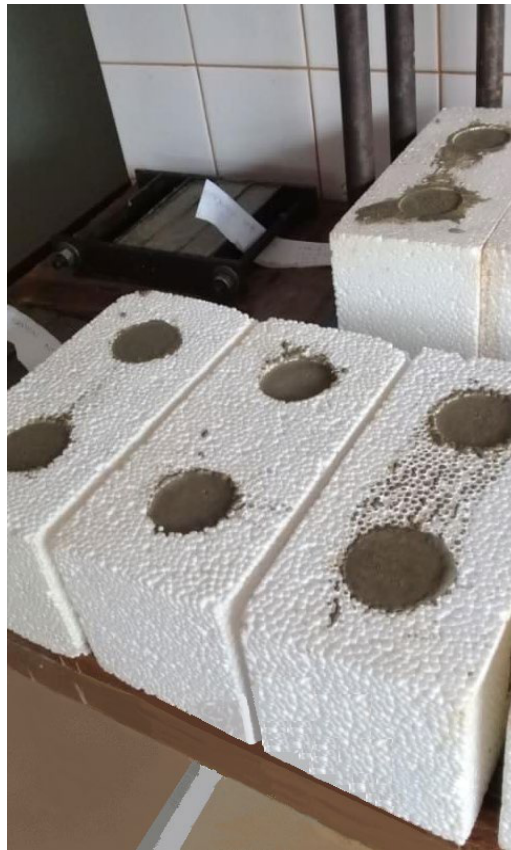
Fig. 2. EPS relleno con mortero de cemento 1:3.
