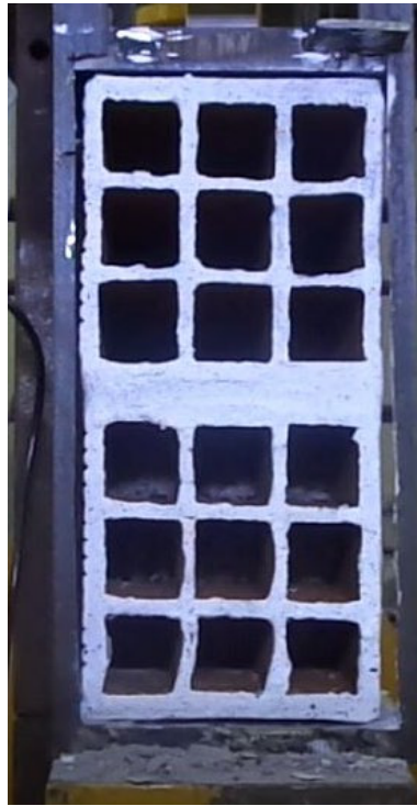
Fig. 7. Jaula de ensayo para celdas de mampostería.
