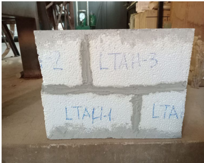
Fig. 4. Ladrillos en formato celdas de EPS unidos con adhesivo para cerámicas.
