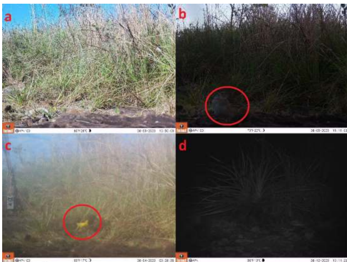
Fig. 1. Ejemplos de imágenes de cámaras trampa sin procesar, ilustrando (a) falsos disparos causados por movimiento de pastizales, (b) fauna objetivo capturada con éxito y poca luz, (c) fauna capturada con condiciones ambientales desafiantes como niebla, y (d) falso disparo nocturno.
