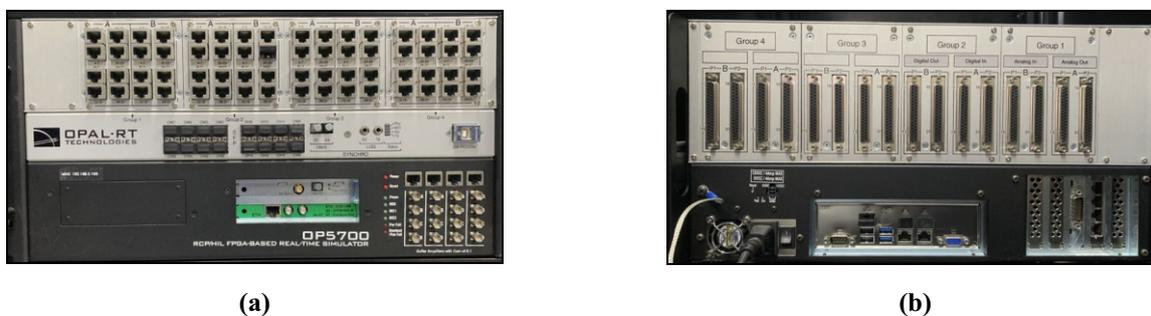
Fig. 1. (a) RTS OPAL-RS modelo OP5700 vista frontal. (b) RTS OPAL-RS modelo OP5700 vista traseira.
