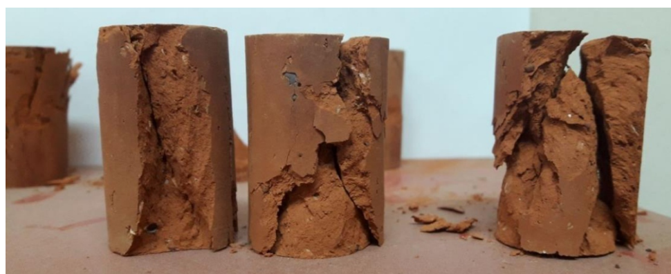
Figura 9. Trayectoria de las fisuras en probetas de cerámica.
