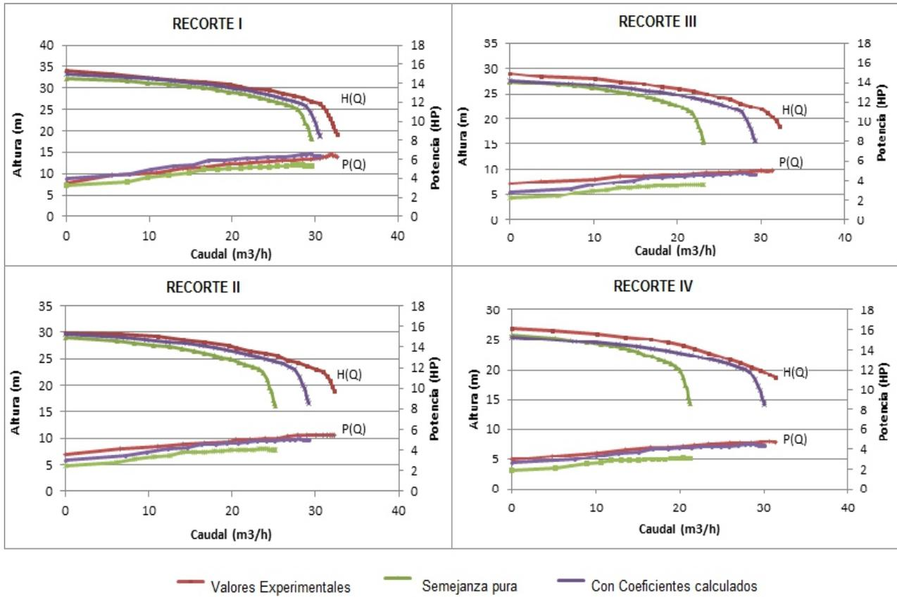
**Fig. 7. Análisis de resultados para la bomba IRUMA 70-7**
