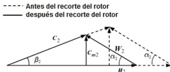
**Fig. 4. Triángulo de Velocidades semejantes a la salida, antes y después del recorte del rotor,  $W_2$ : velocidad relativa,  $C_2$ : velocidad absoluta,  $u_2$ : velocidad periférica,  $C_{m2}$ : velocidad meridiana.**
