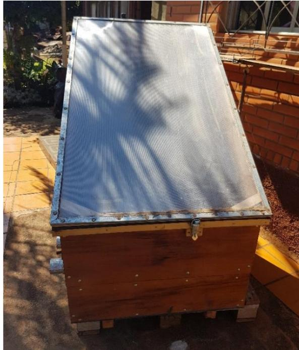
**Fig. 3. Prototipo secador solar vista anterior**
