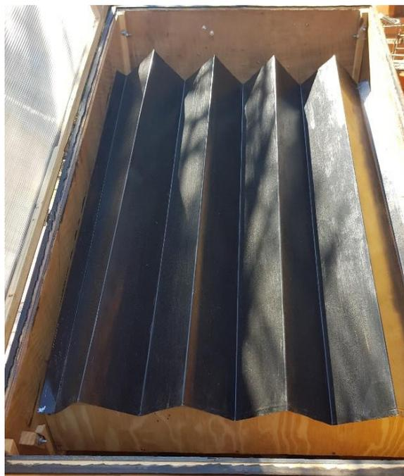
**Fig. 5. Prototipo secador solar. Colector.**
