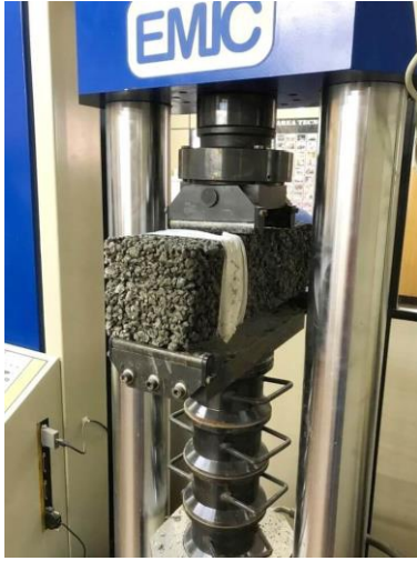
Fig. 3. Ensaio de Resistência à Compressão.
