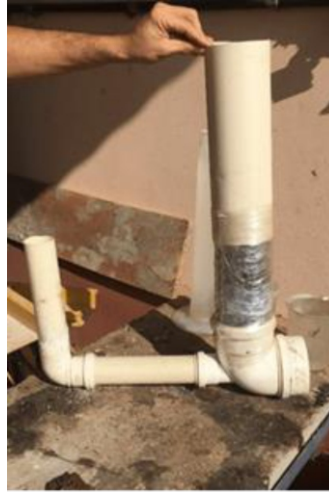
Fig. 2. Permeômetro utilizado no ensaio de Condutividade Hidráulica.
