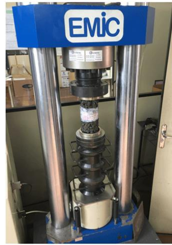
Fig. 4. Realização do ensaio de Resistência à Tração na Flexão.
