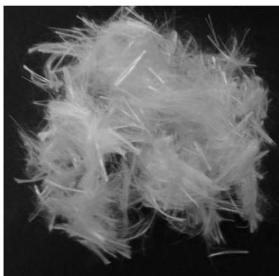
**Fig. 3. Fibras de aramida empregadas (Fonte: Autores)**
