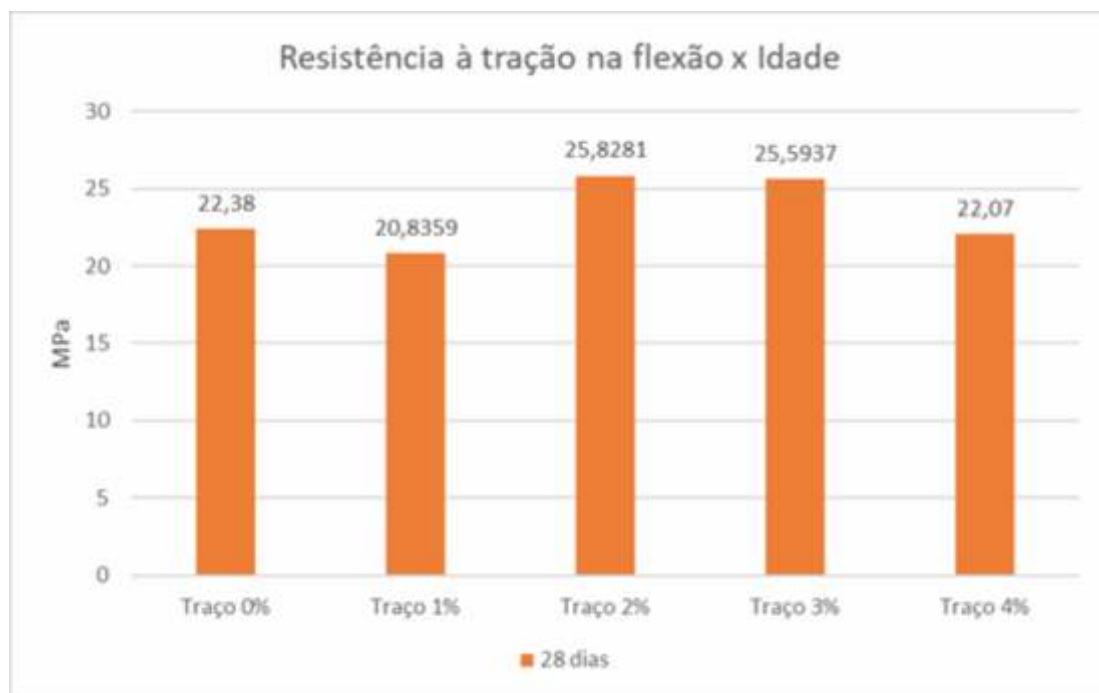
Fig. 5. Comparativo entre os valores de resistência à tração na flexão de acordo com o teor de nanosílica utilizado.
