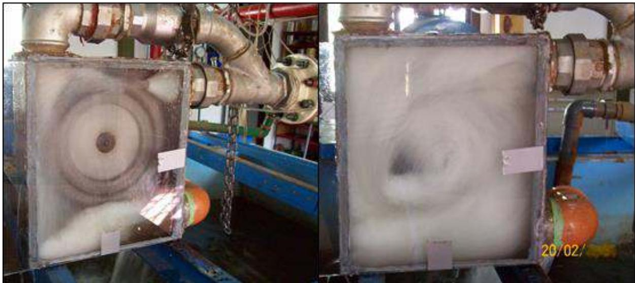
**Fig. 6. Mal funcionamiento de la descarga**
