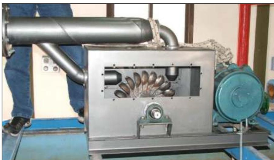
Fig. 11. Turbina tipo Pelton 6 kW
