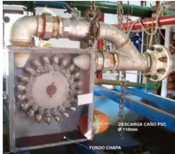
**Fig. 5. Turbina tipo Pelton de 3kW**
